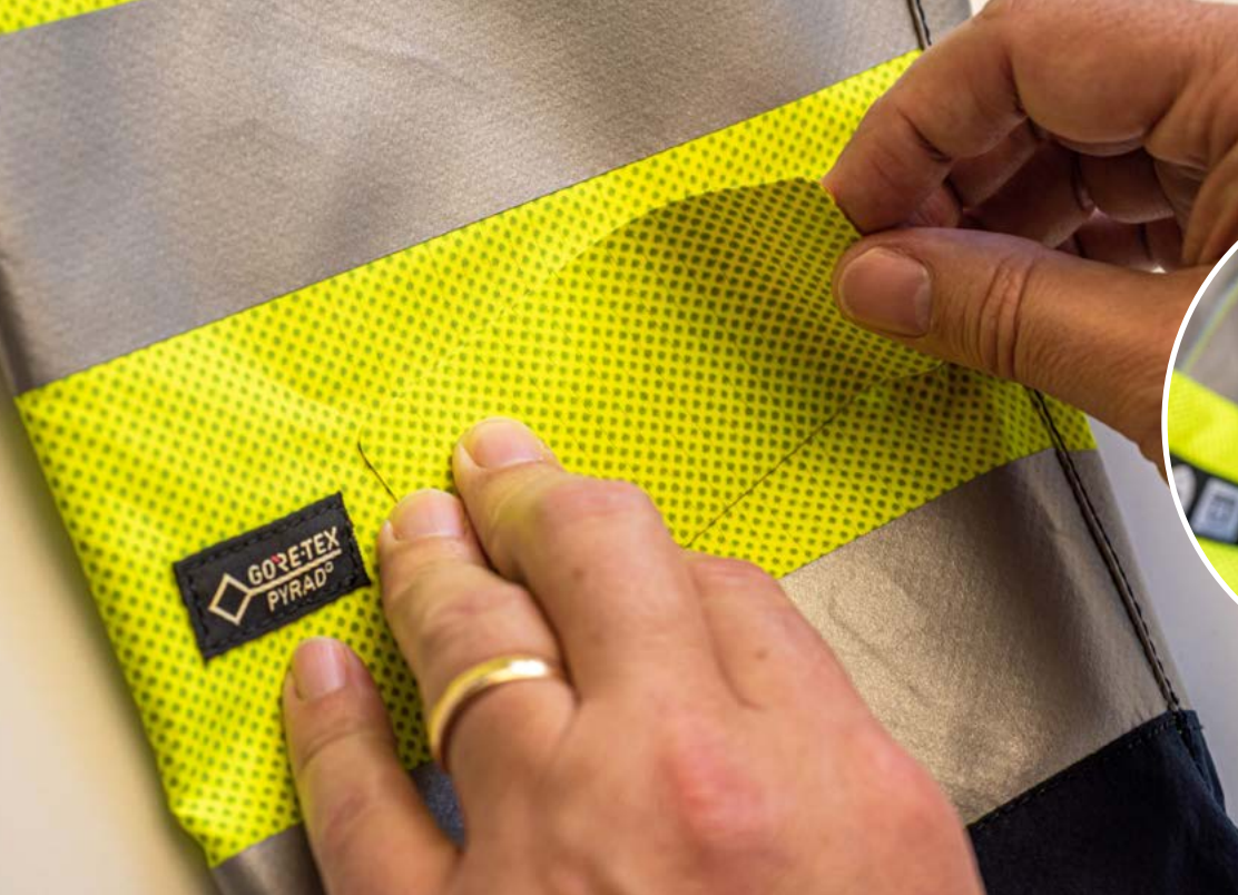
Die mit Klebefolie versehenen Patches werden wahlweise mit einem Föhn oder mit einem Bügeleisen auf der Kleidung angebracht.
